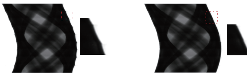
(a) 旧算法外壳扫描正弦图 (b) 新算法外壳扫描正弦图 图13 新旧算法重排正弦图对比 Fig.13 Comparison of new and old algorithms for rebinning of sinogram
